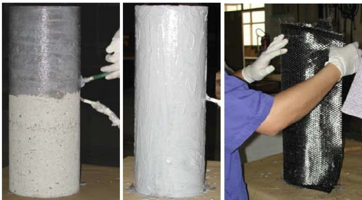
Figura 6 – Aspectos da preparação e aplicação do encamisamento dos pilaretes circulares com PRFC.
