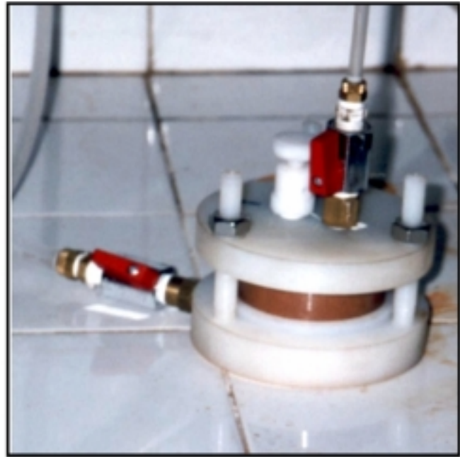
Figuras 3 e 4 – Permeômetro especial de menores dimensões que o indicado nas normas de referência (ABNT NBR - 13292 – 1995 e ABNT NBR-14545 – 2000) para maior rapidez dos ensaios.
