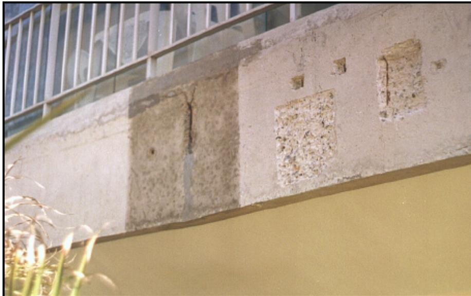
**Figura 10: Áreas de ensaio de aplicação de inibidor tóxico de corrosão e retirada das amostras para elaboração das curvas de polarização para ajuste de dosagem ótima**
